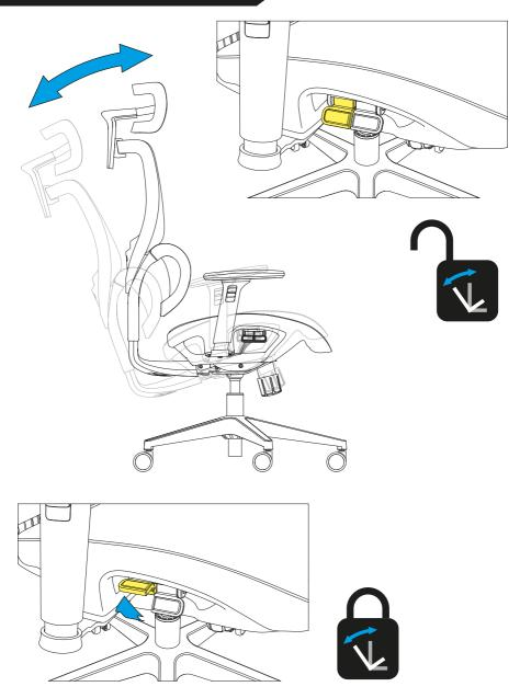
Une fois déverrouillé, une légère pression doit d'abord être appliquée sur le dossier avant que le siège ne soit libéré de l'angle actuellement verrouillé.
