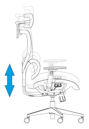
Le siège ne peut être abaissé que lorsqu'il y a une pression sur la base du siège. Le siège ne peut être relevé que lorsqu'il n'y a pas de pression sur la base du siège.
