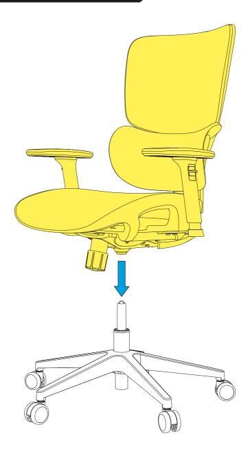
Attention! Afin d'éviter tout dommage matériel et corporel, assurez-vous que le piston de levage par vérin à gaz et le mécanisme du siège soient correctement installés!
