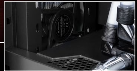
Le couvercle est amovible pour l'installation du radiateur
